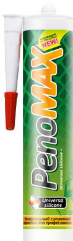
**Герметик силиконовый Penomax Premium Universal Silikone**, технические характеристики: устойчивый к ультрафиолетовому излучению и погодным условиям. Образование поверхностной пленки 10-25 мин, окончательное засыхание 1-2 мм/24 ч, температура использования от +5°С до +40°С, готовое изделие переносит температуру от -40°С до +100°С.
